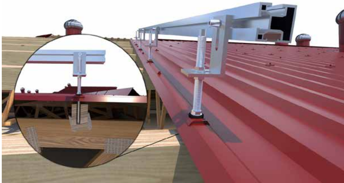
Kotvení fotovoltaických panelů přes trapézový plech až do nosné dřevěné konstrukce.
