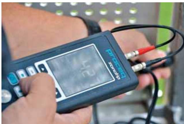
Obrázek 4 Ultrazvukový tloušťkoměr Zonotip pro stanovení tloušťky stěny profilu
