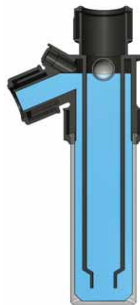
Obr. 3 Sifónový rez v štandardnej prevádzke – guľa „pláva“ na povrchu
