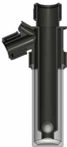
Obr. 2 Prierez sifónu, detail spodnej časti polohy teflónovej guľôčky v prípade prevádzky bez kvapaliny
