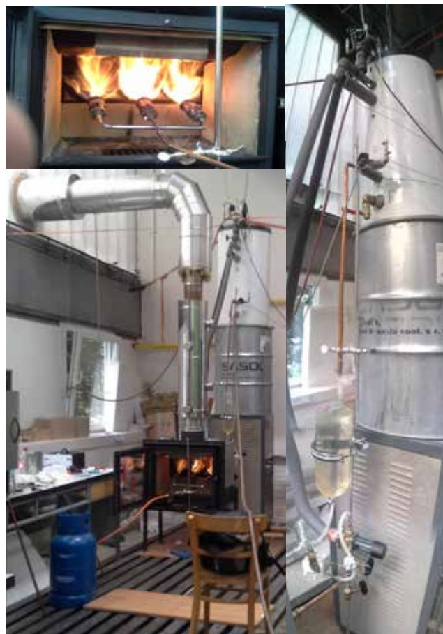
Obr. 2 Meranie tepelných tokov na Loop HP
