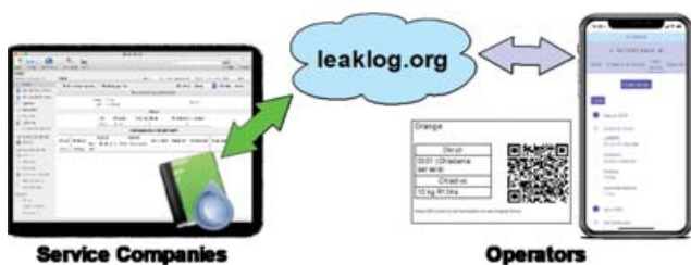
Program Leaklog inštalovaný na PC, web serveri s komunikáciou cez mobily, tablety, štítky s QR odkazom na záznamník s aktuálnymi informáciami
