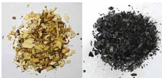
Obr. 3 Štiepka a biouhlie zo zmesi odrôd topoľov
