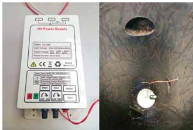
Obr. 4 Zdroj vysokého napätia zapojený na komínový odľučovač
