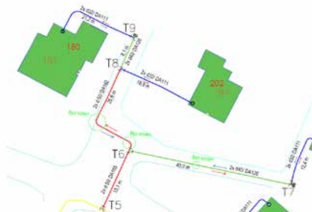
Návrh plánu pre plastové potrubie
