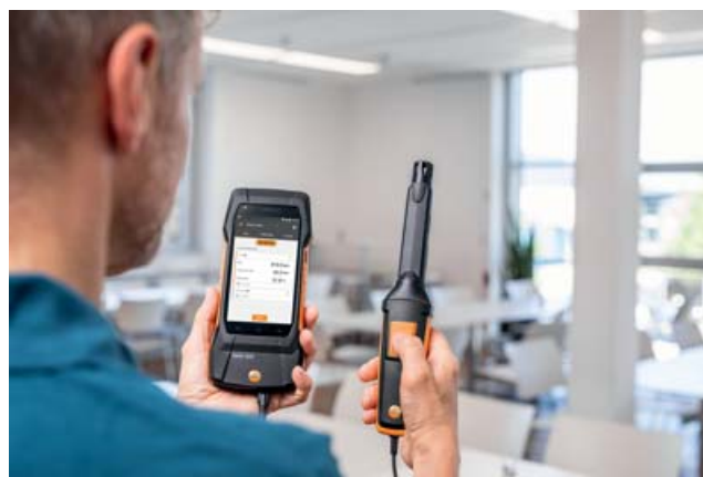
Obr. 2 Měření parametrů kvality vzduchu v budově
