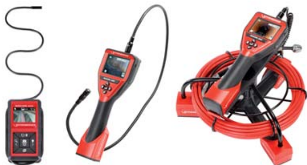
Vľavo: základná kamera s husím krkom predstavujúca základnú kategóriu. V strede: základná kamera s modulom s husím krkom. Vpravo: kamera so zásuvným káblovým modulom, 25 mm hlava.
