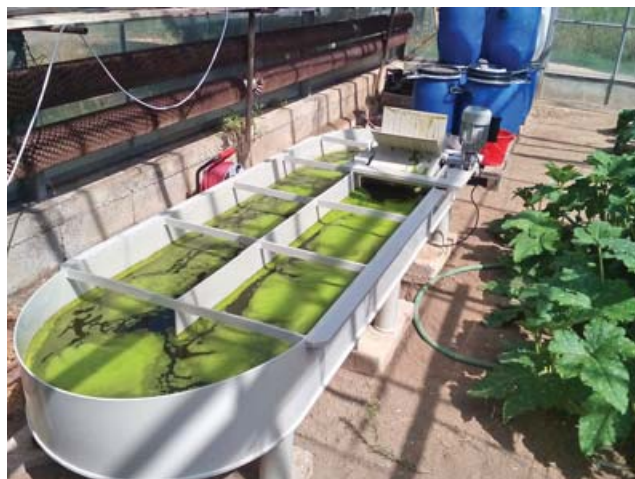
Obr. 4 Otvorený fotobioreaktor so zelenými mikroriasami druhu Chlorella sorokiniana (fotografia autor)
