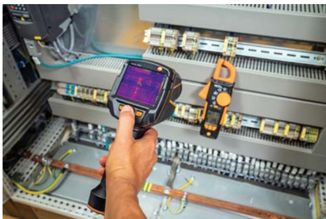
Obr. 3 Využití klešťového multimetru testo 770-3 při paralelním měření s termokamerou testo 883
