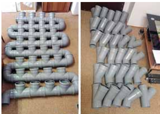
Obr. 2 Plastové potrubie použité na tvorbu experimentálnej zelenej steny
