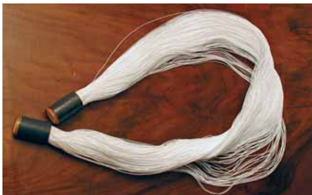
Obr. 1 Výmenník tepla z polyuretánových vlákien
