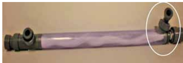
Obr. 6 Výmenník typu Tube and Shell s tangenciálnym vstupom
