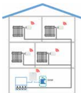
Príklad systému s ovládaním radiátorov
