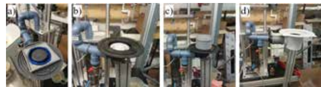
Obr.6 Vzorky použitých podlahových/sprchových vpustov a) podlahový vpust s výškou vodného uzáveru 30mm a zvýšenou tlakovou odolnosťou, b) podlahový vpust s výškou vodného uzáveru 30 mm, c) podlahový vpust s výškou vodného uzáveru 50 mm, d) podlahový vpust s výškou vodného uzáveru 60 mm, Poznámka: vpusty s výškou vodného uzáveru 40 mm sa nevyrábajú
