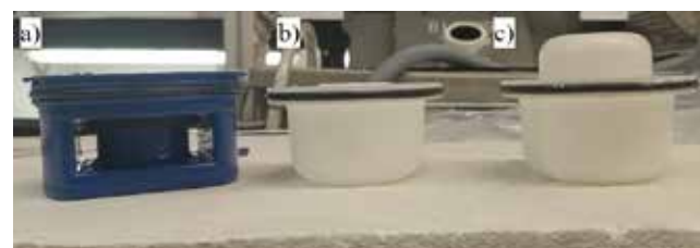
Obr.7 Zápachové uzávierky vo vybraných vpustoch a) zápachová uzávierka s výškou vodného uzáveru 30 mm a zvýšenou tlakovou odolnosťou, b) zápachová uzávierka s výškou vodného uzáveru 30 mm, c) zápachová uzávierka s výškou vodného uzáveru 50 mm
