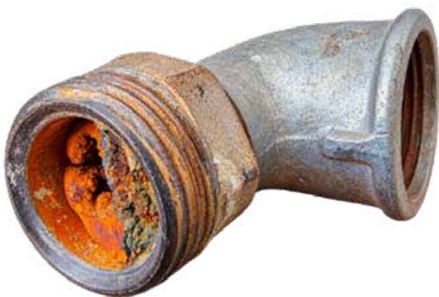
Korózia potrubí a armatúr vplyvom agresívnych vlastností vody
