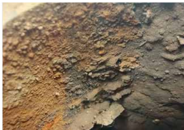
Korózia potrubí a armatúr vplyvom agresívnych vlastností vody
