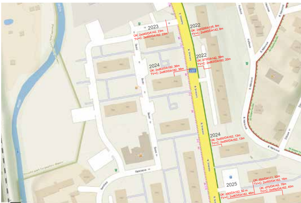
Obr. 3 Rekonštruované prípojky tepelných rozvodov - potrubia NRG FibreFlex
