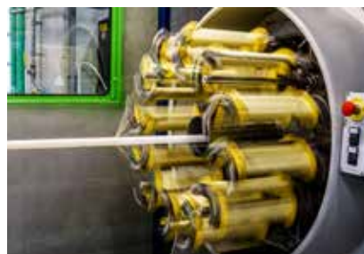
Tkanie aramidovými vláknami okolo hotovej PE-Xa rúrky
