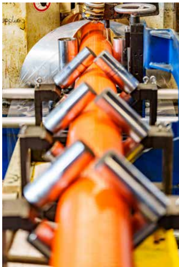
Centrovanie rúrky pre médium pred vypeňovacou hlavou. Vzadu je vidieť vypeňovanie potrubí.
