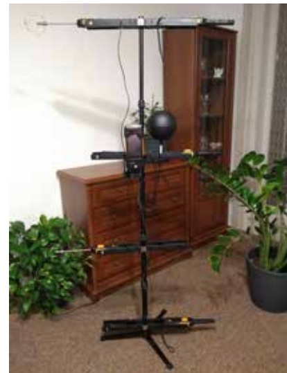
Obr. 1 Rozmiestnenie meracích sond na konkrétnom meracom mieste
