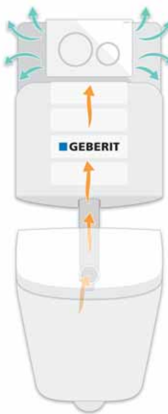
Zápach sa odsáva priamo z WC misy a po prečistení vo voštinovom filtri za tlačidlom sa vracia späť do miestnosti.
