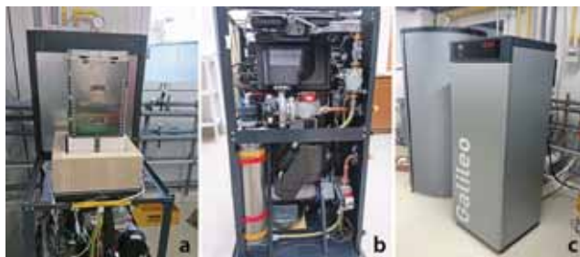
Obr. 1 Mikrokogeneračná jednotka s palivovými článkami, a) pohľad na modul palivových článkov – vrchná časť jednotky b) pohľad na integrovaný kondenzačný kotol – spodná časť jednotky c) zostavená mikrokogeneračná jednotka
