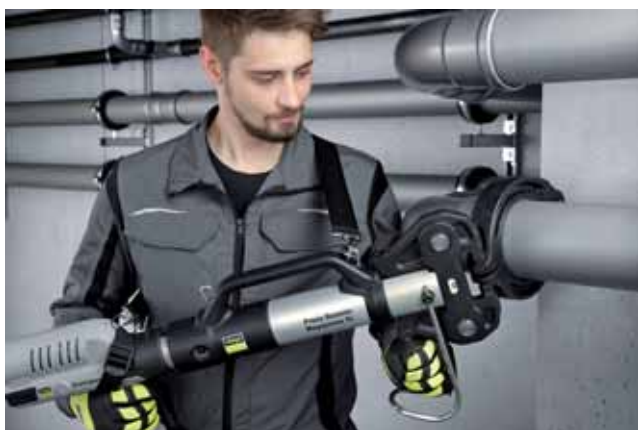
S nástrojom Viega Pressgun Press Booster možno pohodlne a rýchlo lisovať dimenzie až do 4 palcov. (foto: Viega)
