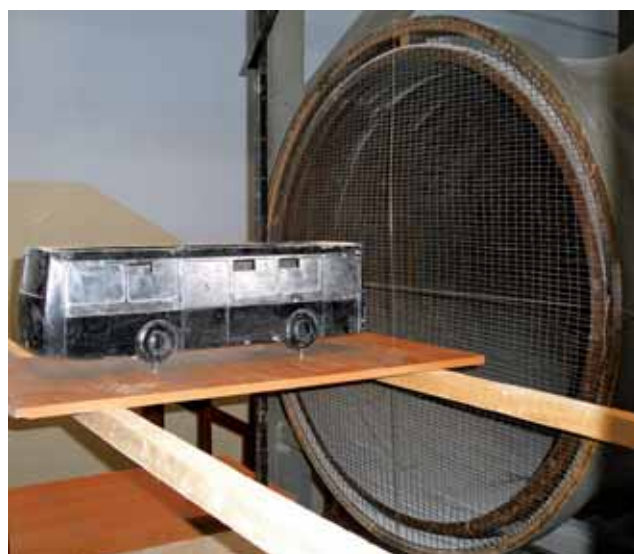
Obr. 3 Dutý model autobusu LAZ 42021 v aerodynamickom tuneli. Zdroj: archív autora.
