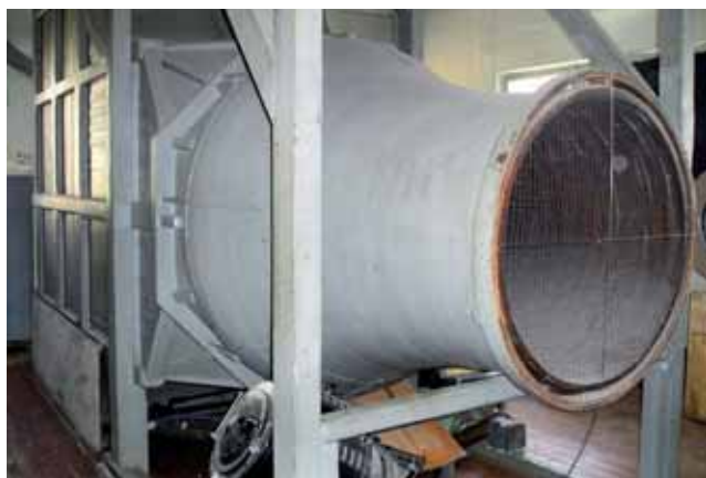
Obr. 2 Pracovná časť aerodynamického tunela. Zdroj: archív autora.
