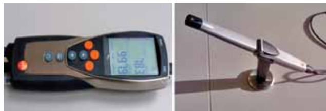
Obr. 3 Multifunkčný merací prístroj TESTO 435 - 4 + senzor Testo 0632
